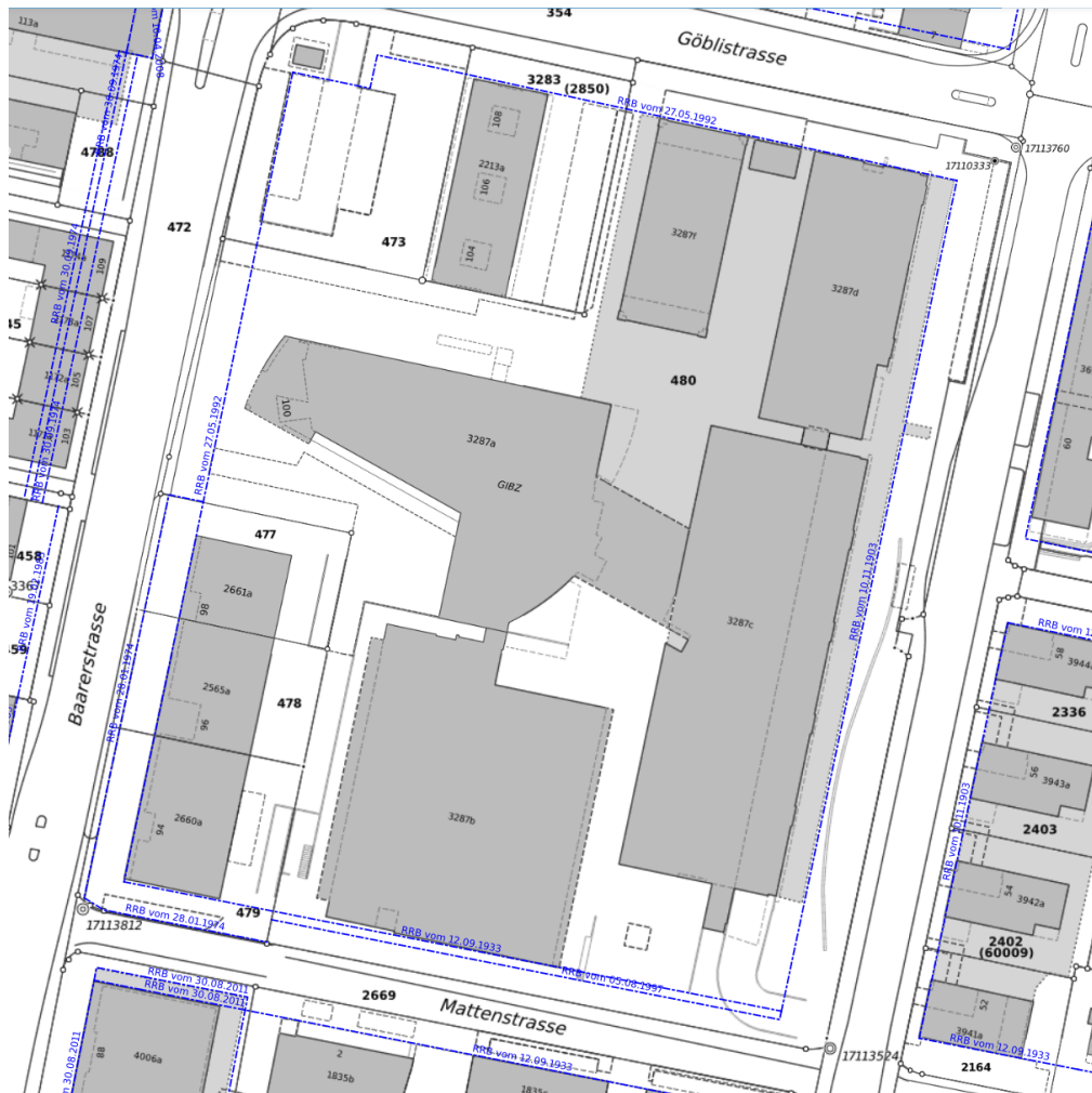
Abbildung 9: Bestehende Baulinien im Geviert GIBZ. Quelle: ZugMap
