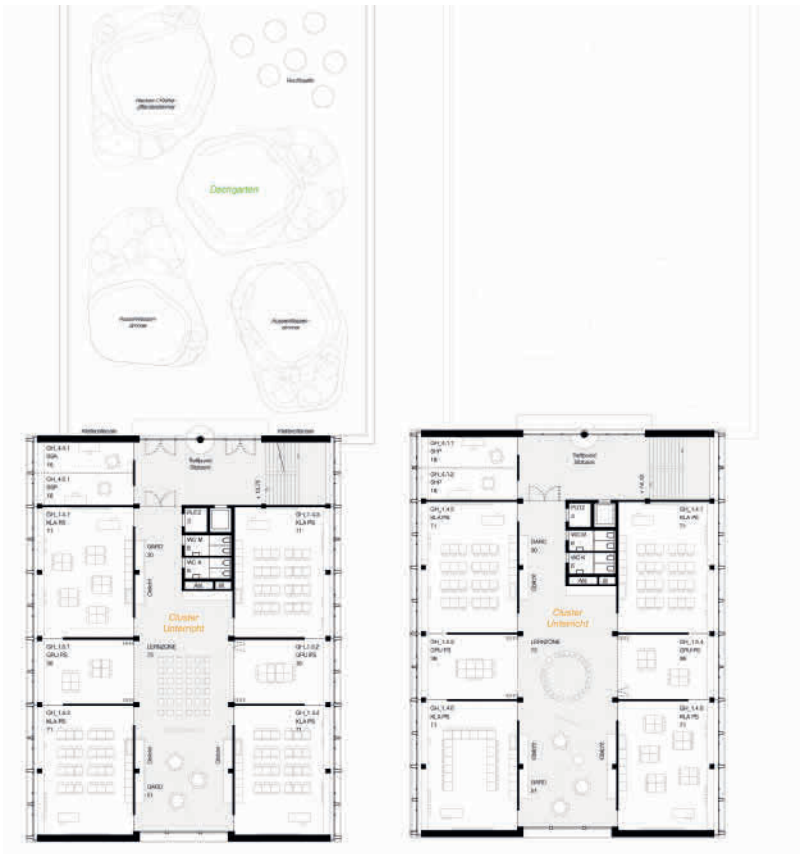
Grundrisse 3./4. Obergeschoss MST 1:200 (verkleinert)
