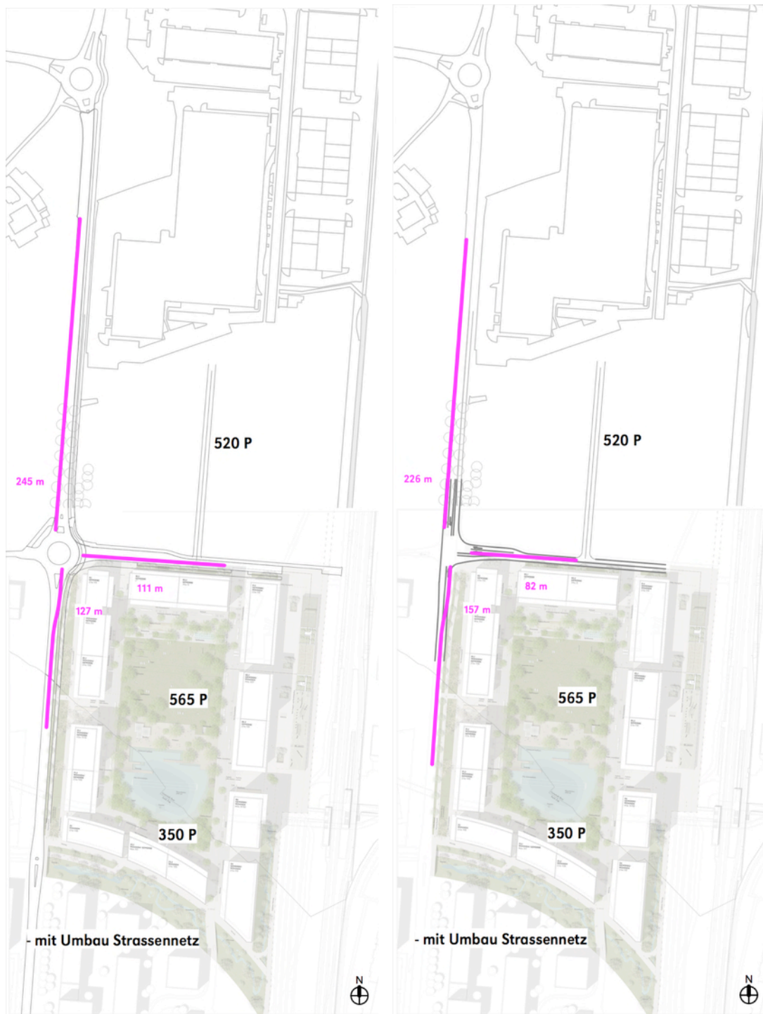
Abbildung 7: Rückstaulängen am Knoten Unterfeld als Kreisel und LSA, mit Optimierung des übergeordneten Strassennetzes
